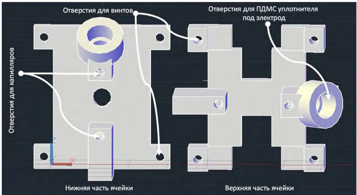
Рисунок 3.5 – 3D-модель электрохимической ячейки с оптическим доступом
