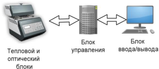
Рис.1 - Общая схема прибора для проведения ПЦР-РВ
