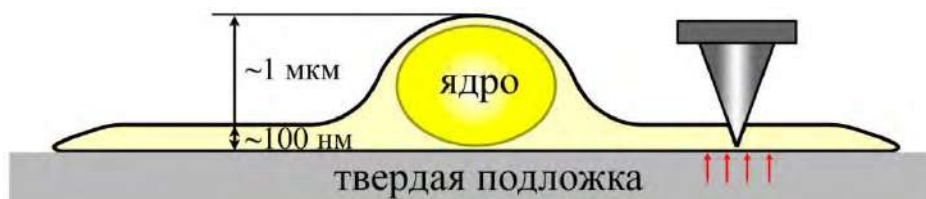
Рисунок 6 - Схематичное изображение культивируемой на подложке ЭК, поясняющее специфику зондирования ее периферии.
