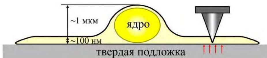
Рисунок 5 - Схематичное изображение культивированной на подложке ЭК, поясняющее специфику зондирования ее периферии.
