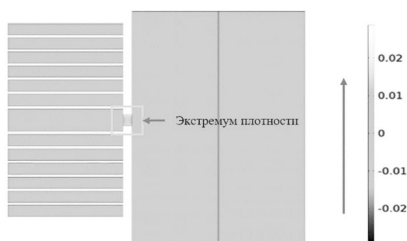
Рис. 6. Схема принципа звукопоглощения. Распределение плотности потерь энергии
