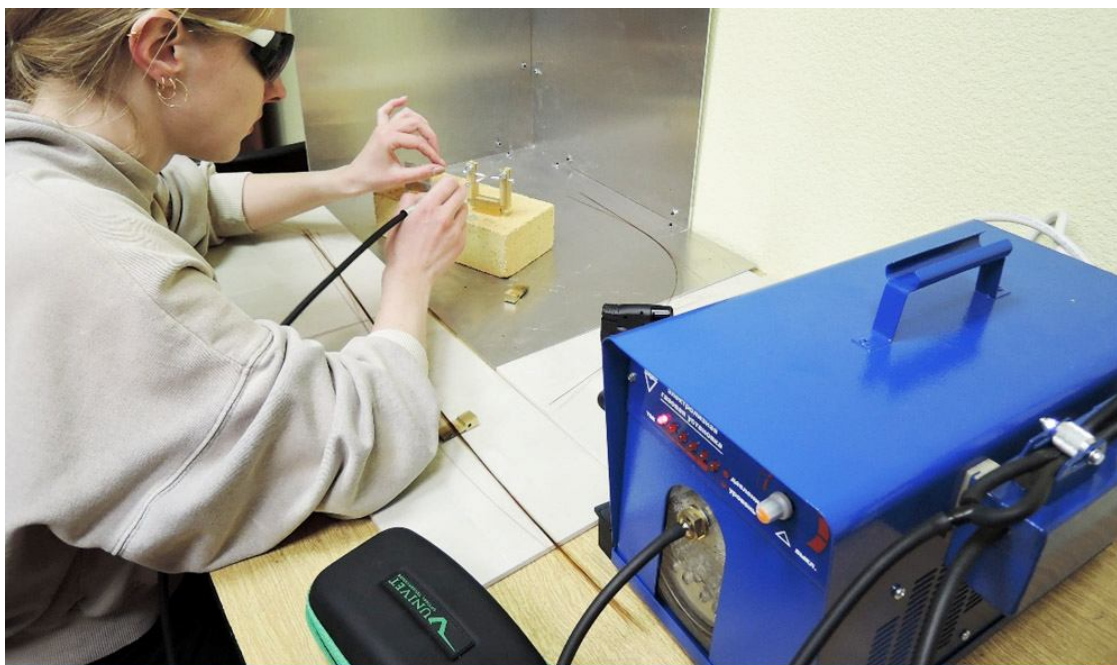
Рис. 2. Водородная горелка "Лига-02С", используемая для удаления защитной оболочки с кварцевых капилляров
