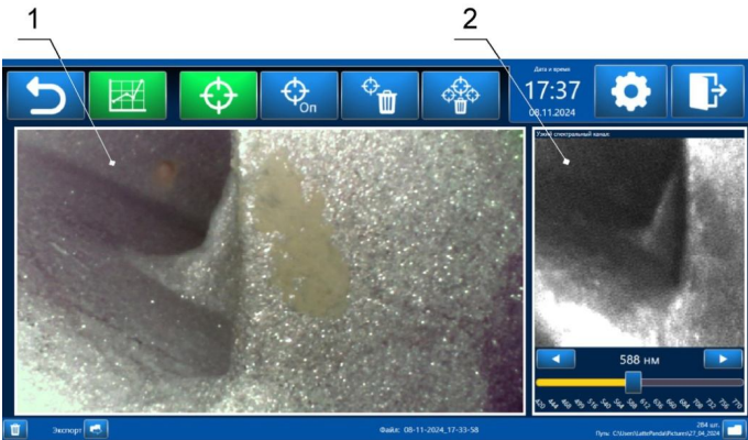
Рис. П1. Главное окно управляющей программы. 1 — изображение широкополосного канала, 2 — изображение одного из спектральных каналов
