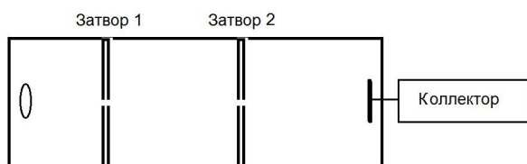
Рис. 1. Общий вид ион-дрейфового спектрометра с двумя затворами
