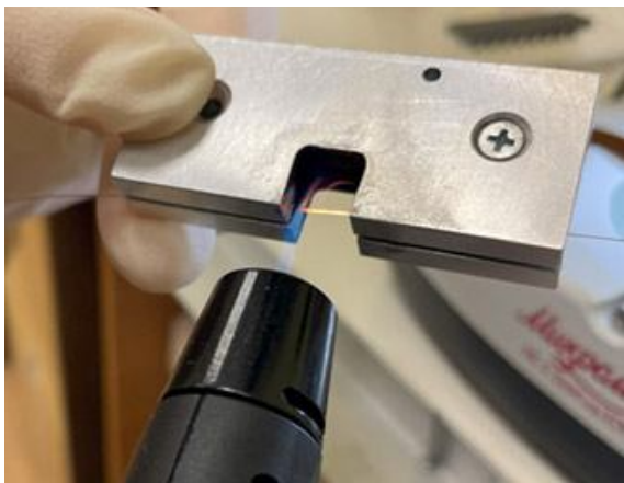
Рис. 1. Процесс очистки кварцевых капилляров при помощи газовой горелки.
