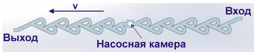
Рис. 28. Геометрия микронасоса на основе двух клапанов Теслы, соединенных последовательно через насосную камеру [59]
