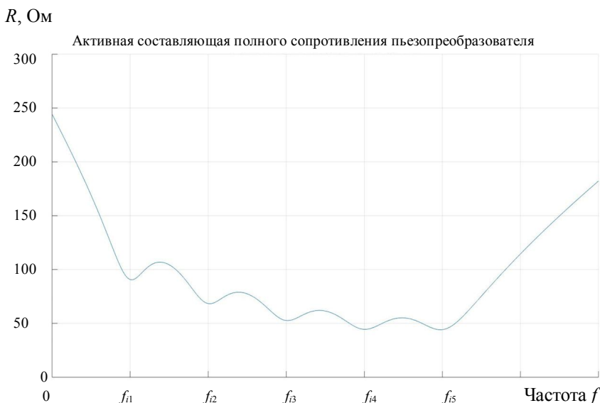
Рис. 4. Зависимость активной составляющей полного сопротивления от частоты при параллельном соединении пьезоэлементов в широкополосном преобразователе
