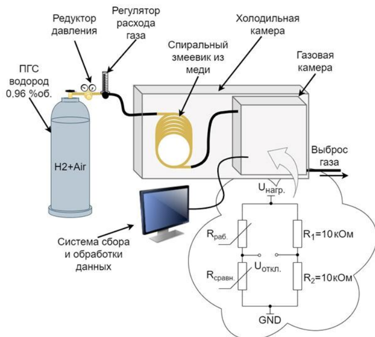
Рис. 1. Блок-схема измерительной системы
