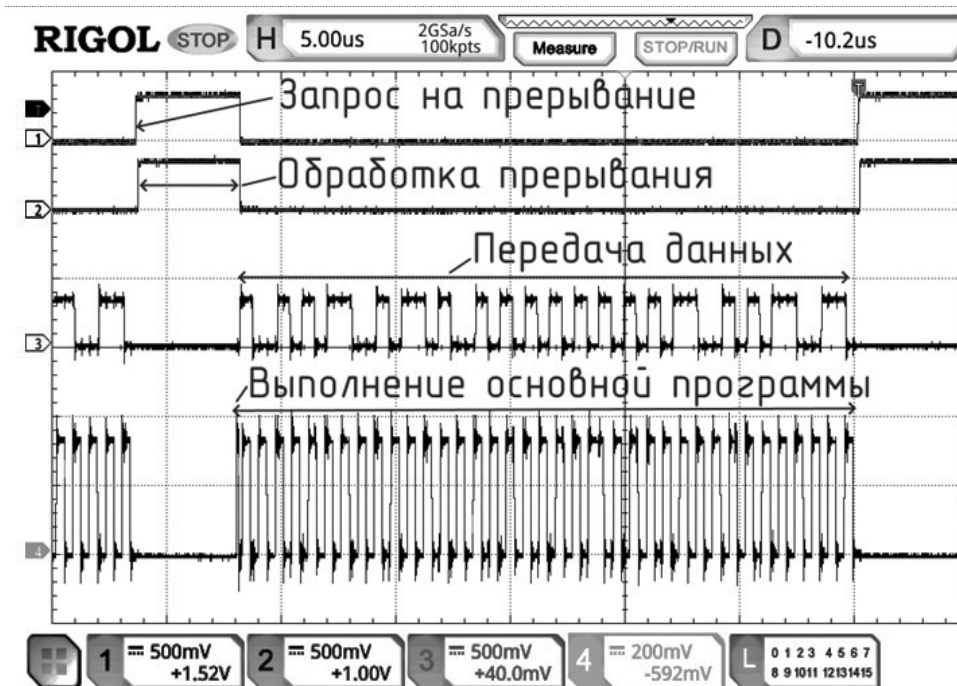
Рис. 3. Осциллограммы исполнения тестовой программы из табл.
