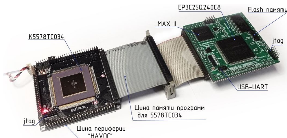
Рис. 2. Отладочные комплекты систем на ядре "NMR" с использованием разных ИМС FPGA
