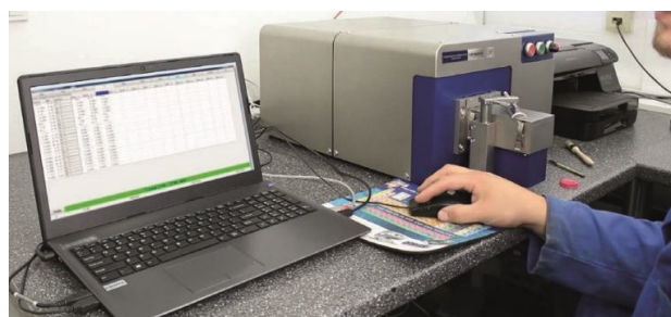
Рис. 7. Искровой опико-эмиссионный спектрометр Foundry-Master Smart (стенды компаний Мелитэк, ИМС)
