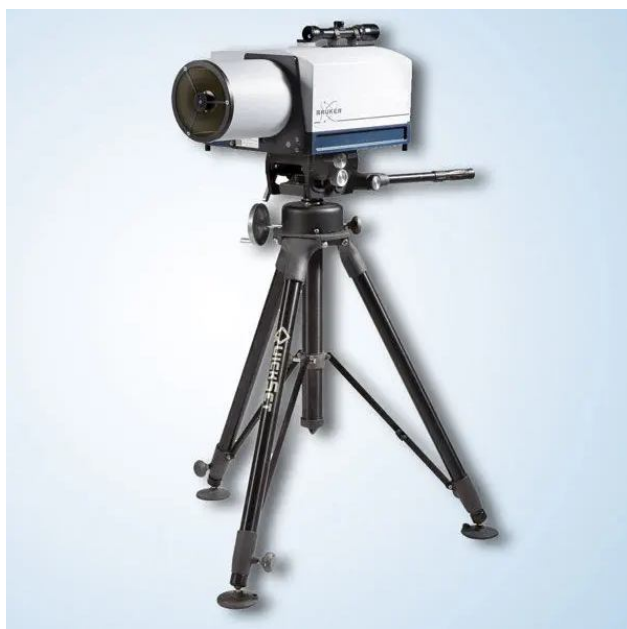
Рис. 4. ИК-спектрометр FT-IR EM27 (Bruker Optics, Германия) для экологических приложений
