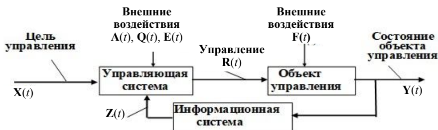
Рис. 1. Обобщенная структурная схема системы управления принципно любым техническим объектом (процессом)
