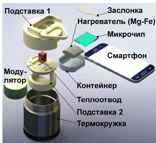
Рис. 13. Система для количественного анализа нуклеиновых кислот с микрочипом для LAMP, химическим нагревателем и детектором флуоресценции в режиме реального времени на основе смартфона [47]
