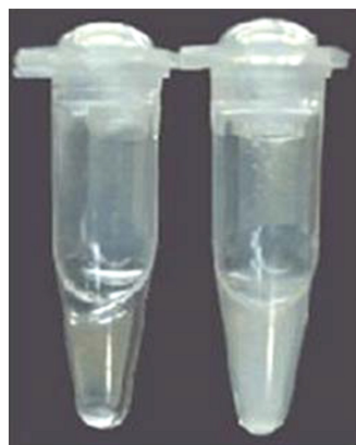
Рис. 5. Детектирование реакции LAMP по мутности. Слева — без мишени (отрицательный контроль); справа — с ДНК-мишенью (положительная реакция) [13]
