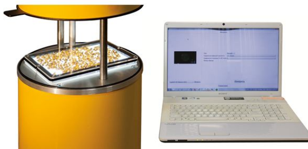
Рис. 2. Диафаноскоп "Янтарь" с кассетой и компьютером
