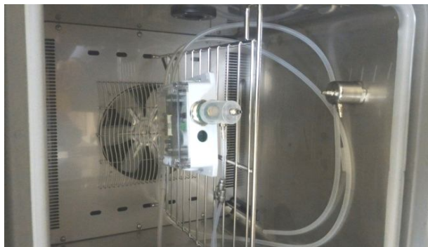
Рис. 1. Контейнер с датчиком в корпусе ТО-8 (во взрывозащищенном исполнении) в термостате
