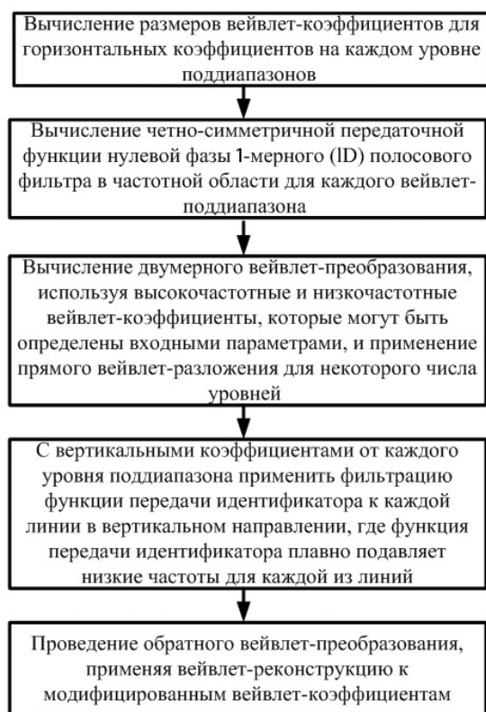
Рис. 2. Алгоритм удаления горизонтальных полос
