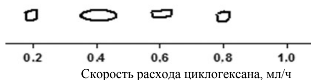
Рис. 4. Зависимость формы капли эмульсии циклогексана от скорости расхода циклогексана (по результатам оптической микроскопии капля эмульсии циклогексана в воде рис. 2, 3). Концентрация ДСН — 5 ККМ
