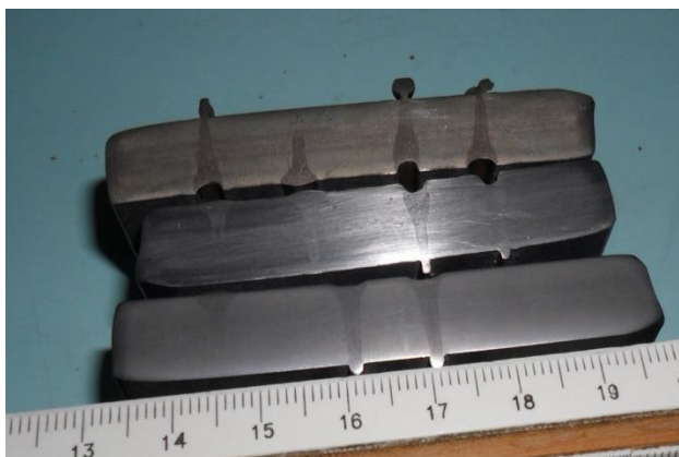
Рис. 7. Образцы проплава нержавеющей стали толщиной 10 мм
