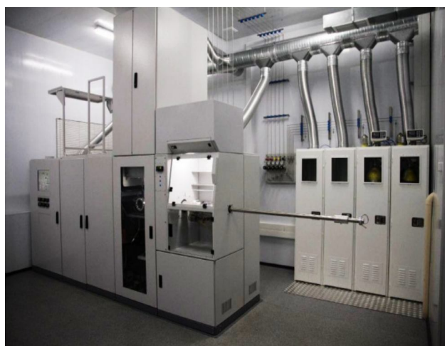
Рис. 1. Установка для выращивания объемных эпитаксиальных слоев GaN
