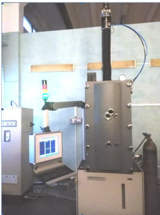
Рис. П6. Установка для промышленного выращивания профилированного сапфира, производимая ФГУП ЭЗАН
