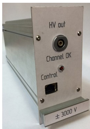
Фото высоковольтного двухполярного блока питания с изолированным выходом ВВБП-3000-2(3000 В) (см. табл. 1)
