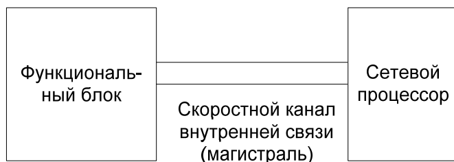
Рис. 2. Унифицированная структура модулей в системе МОДУС-НС
