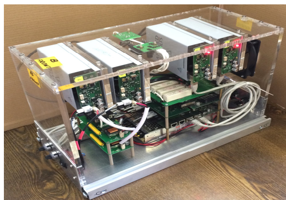
Рис. 2. Фото блока цифровой и аналоговой электроники спектрометра ионной подвижности в изолирующем корпусе без внешнего корпуса
