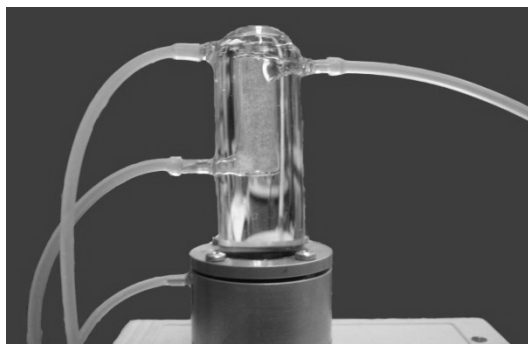
Рис. 1. Внешний вид ультразвуковой суспензионной колонки
