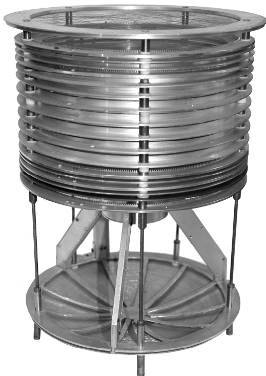
Рис. 7. Внешний вид газопылевого масс-спектрометра
