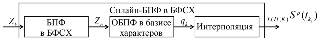
Рис. 3. Принцип реализации процедур интерполяции в БФСХ
