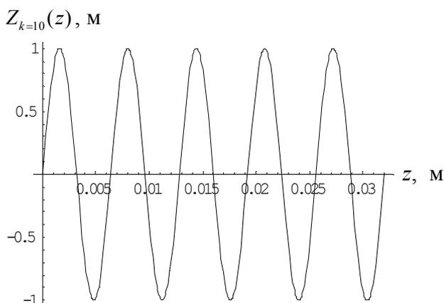
Рис. 4. Продольная собственная функция  $Z_{k=10}(z)$ . От частоты зависимость отсутствует
