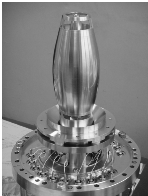
Рис. П7. Фото внешнего и внутреннего электродов анализатора сферического типа SEA 124-220-45. Здесь же видна электронная пушка, встроенная во внутренний электрод анализатора
