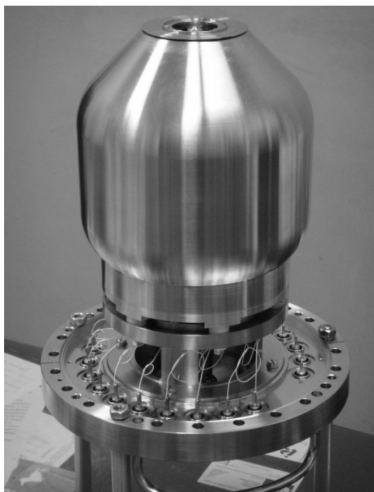
Рис. П7. Фото внешнего и внутреннего электродов анализатора сферического типа SEA 124-220-45. Здесь же видна электронная пушка, встроенная во внутренний электрод анализатора
