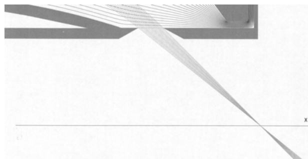
Рис. П2. Выходная часть электронно-оптической системы анализатора
