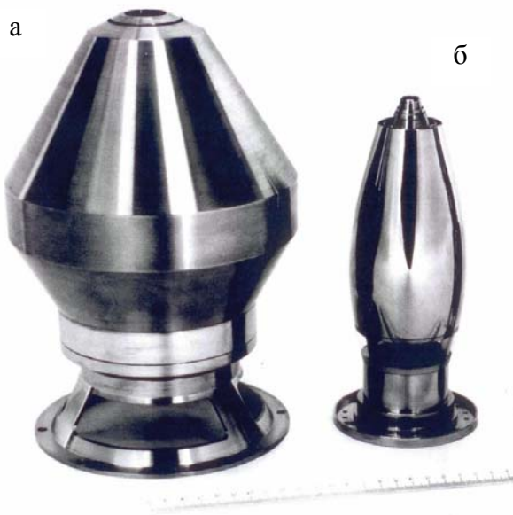
Рис. 3. Фото энергоанализатора (а) и его внутреннего электрода (б)
