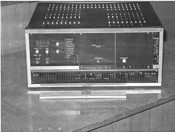
Рис. 1. Малогабаритный электронный блок питания квадрупольного масс-спектрометра
