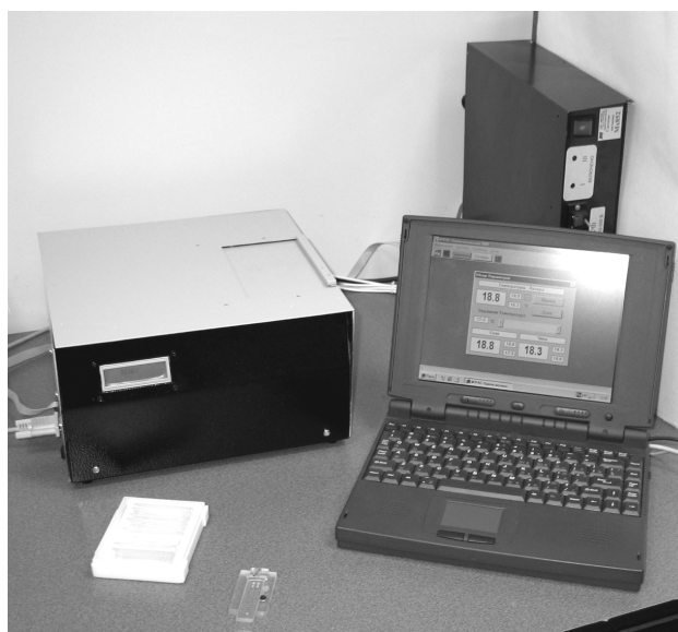
Рис. 1. Прототип микрофлюидной аналитической системы (пМФАС, ИАНП РАН)
