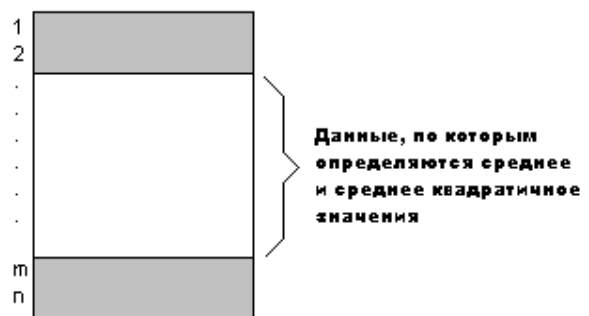
Рис. 2. Упорядоченная выборка обрабатываемых данных, построенная в порядке возрастания чисел. Темным фоном показаны числа, которые не участвуют в определении среднего и среднего квадратичного значений выборки
