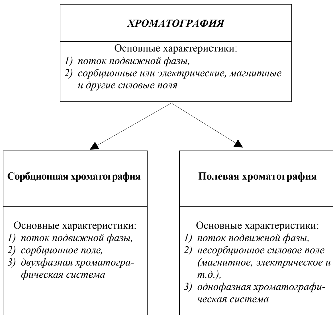
Схема основных вариантов хроматографии
