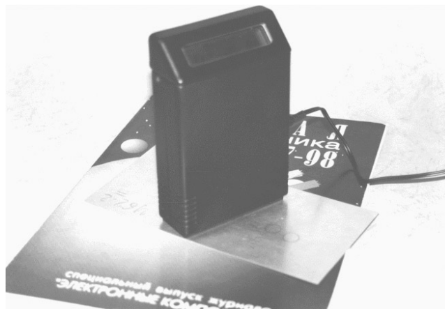
Внешний вид разработанного оптического дистанционного измерителя шероховатости
