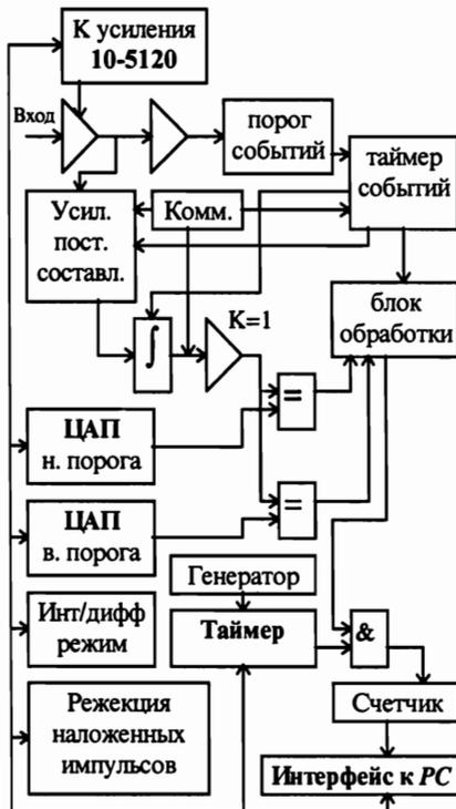
Рис. 4. Модуль обработки сигнала с рентгеновского пропорционального счетчика (модуль 11). Упрощенная схема
