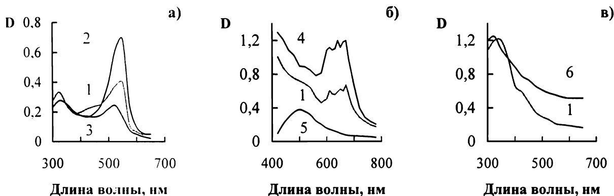
Рис. 1. Спектры поглощения пористого стекла при 20°C с закрепленными на его поверхности молекулами индикаторного вещества на основе: а — фенолфталеина, б — хлорида кобальта (II), в — хлорида палладия (II).
