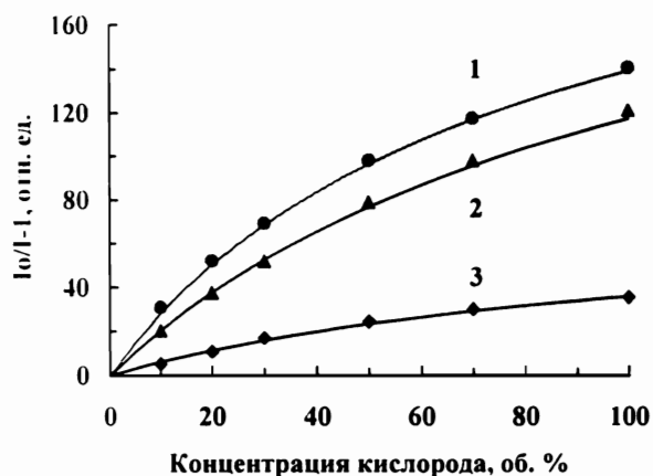
Рис. 4. Графики тушения кислородом интенсивности люминесценции комплексов [\text{Ru}(\text{Ph}_2\text{phen})_3]^{2+} (1), [\text{Ru}(\text{phen})_3]^{2+} (2), [\text{Ru}(\text{bpy})_3]^{2+} (3) в пористом стекле.
