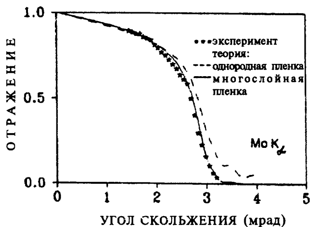
Рис. 1. Кривая зеркального отражения излучения \text{MoK}_\alpha от исходного образца (точки — эксперимент, линии — теория). Пунктирная кривая рассчитана для модели однородной пленки ^{57}\text{Fe} толщиной ~ 50 нм, сплошная линия — результат подгонки модели многослойной пленки с пониженной плотностью приповерхностного слоя.
