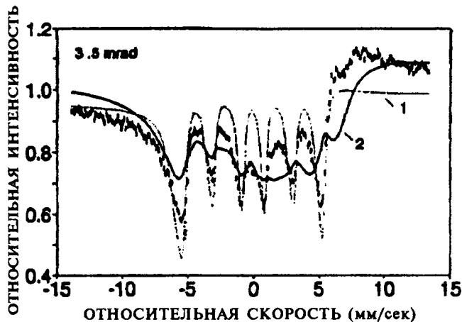
Рис. 4. Мессбауэровский спектр зеркального отражения от исходного образца для угла скольжения q = 3,5 мрад (точки) и теоретический спектр зеркального отражения, рассчитанный для двух простых моделей: однородная пленка \alpha -Fe (кривая 1) и многослойная пленка, в которой каждый слой характеризуется одним сверхтонким взаимодействием (кривая 2).
