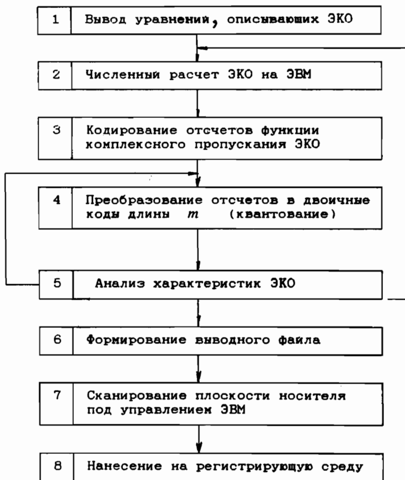
Рис. 1. Этапы синтеза элементов компьютерной оптики. Объяснение в тексте.
