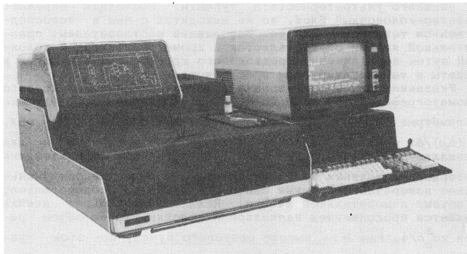
Рис. 5. Жидкостный хроматограф ХЖ1315 (НТО АН СССР). Расход элюента 0.5–30 мкл/мин, нестабильность насоса 0.1 %. Рабочее давление 12 МПа. Колонка 0.5×300 мм. Объем дозирования 0.04; 0.2; 0.5; 0.75 и 1 мкл. Соединительный объем колонки и измерительной ячейки детектора 0.1 мкл. Рефрактометрический детектор, пределы измерения: 0-0.5 \cdot 10^{-6} ; 0-1.0 \cdot 10^{-5} ; 0-2 \cdot 10^{-5} ; 0-4 \cdot 10^{-5} ; 0-8 \cdot 10^{-5} ед. рефракции. Предельная чувствительность 5 \cdot 10^{-5} ед. рефракции. Объем измерительной ячейки 0.1 мкл. Габаритные размеры 580×710×175 мм. Масса 70 кг
